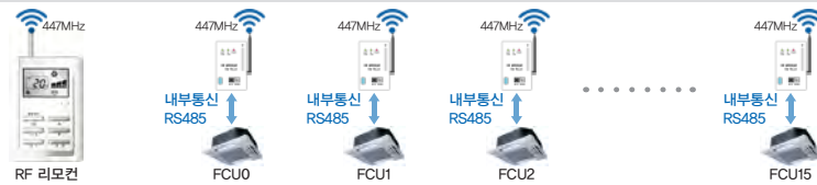
RF 리모컨과 Master FCU의 RF 모듈 무선통신, Slave FCU와는 RS485 유선통신(무선+유선)
